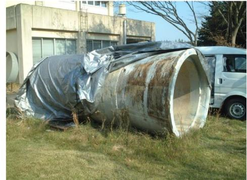
Fig. 11. 実験に用いた導水管
