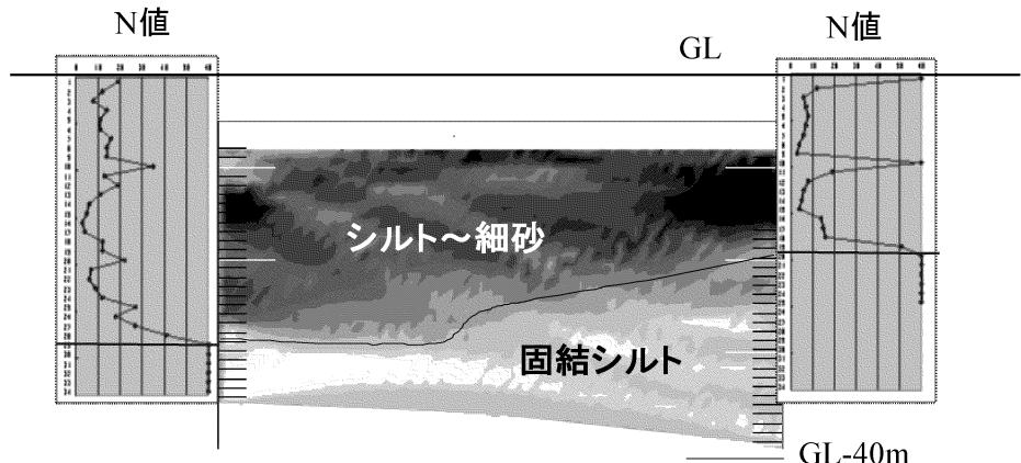
図 2 解析結果(速度分布図)
